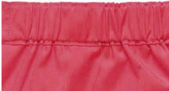
Görsel 5.9: Lastikle bel temizleme çalışması üst dikiş
