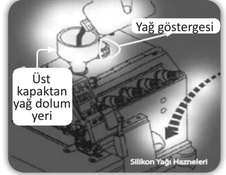
Şekil 2.28: Üst kapaktan yağ dolumu
