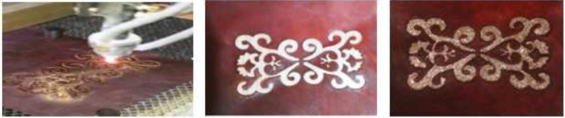
Görsel 2.118: Lazer kesim yöntemi ile yapılan aşamalı applike görselleri
