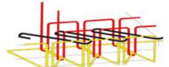
Şekil 2.20: 5 iplik overlok dikişi oluşumu
