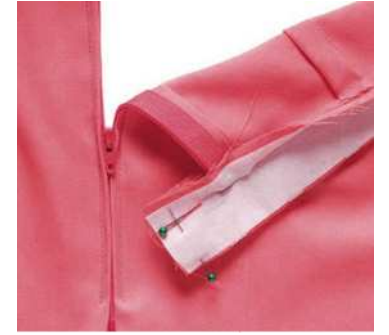
Görsel 5.6: Kemer telası ile bel temizleme çalışması kemer dikimi
