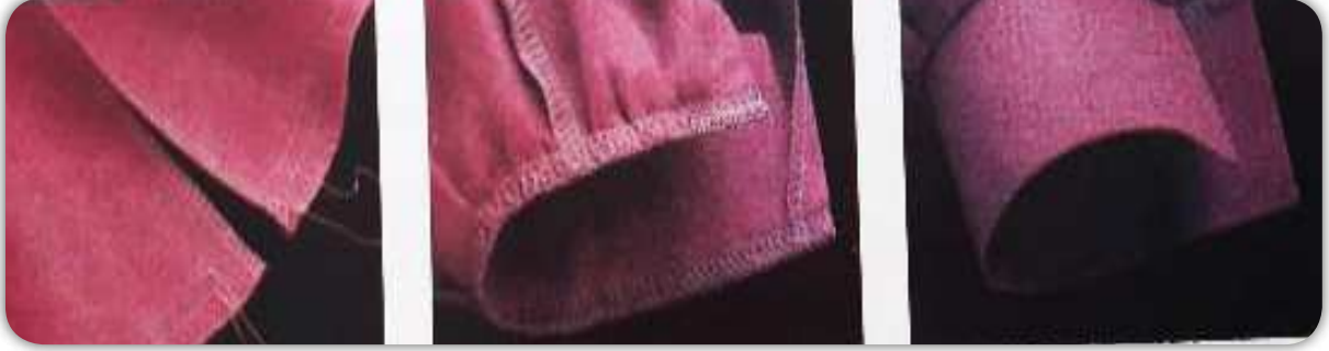
Görsel 2.57: Overlok makinesinde manşet birleştirme dikişi
