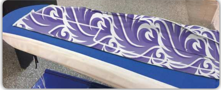
Görsel 5.11: Overlok ile temizlenmiş yırtmaç kenarı
