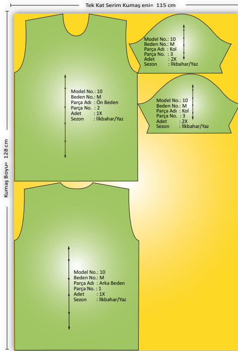
Şekil 6.8: Kalıbın tek kat kumaşa yerleştirilmesi
