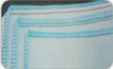
Görsel 2.53: Hatalı ve doğru dikişler
